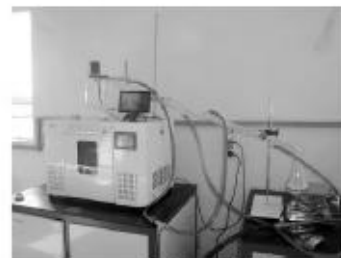
图1 MKX-H1C1微波化学试验炉组装示意图
